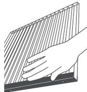
Нижний торец следует закрывать перфорированной лентой, защищающей соты от попадания грязи и пыли.
