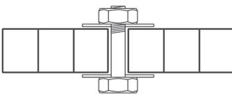
При креплении панелей винтовым соединением или саморезом диаметр отверстия должен быть на 2 мм больше диаметра винта или самореза. Не перетягивать винты, оставляя зазор на свободный ход.
